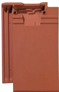
La production de la Fontenelle a débuté en décembre 2008. Tuile petit moule d'aspect plat, elle est conçue avec un nez fin et des lignes modernes. D'une densité de 19,7 à 21,2 tuiles au mètre carré, elle bénéficie d'un double emboîtement latéral et offre une flexibilité jusqu'à deux centimètres longitudinalement. Elle est proposée en Rouge Naturel, Rouge Vieilli et Anthracite.
