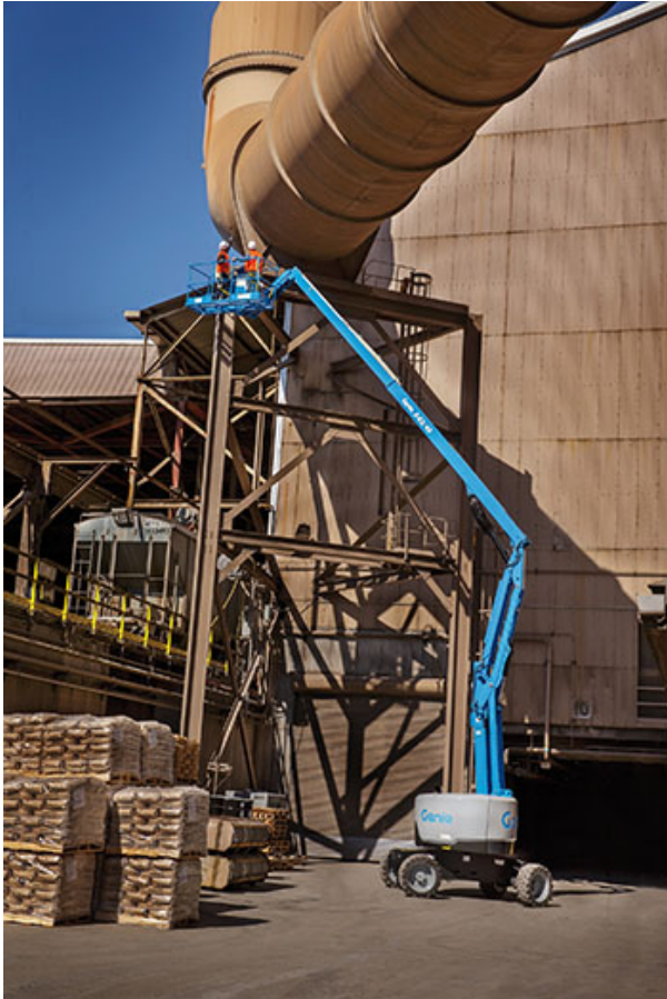
La nacelle à bras articulé diesel Z 62/40 de Génie
