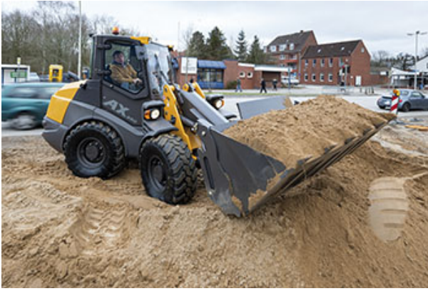
La chargeuse frontale articulée 5 tonnes Mecalac AX
