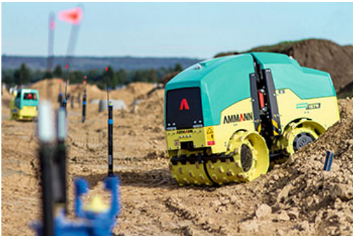
Le compacteur de tranchée articulé Rammax 1575 d'
