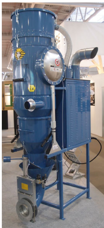
Centrale d'aspiration DG-RBP
