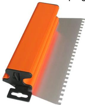
Outre le Projoint, l'entreprise présentait l'Ergolame, un outil multi-usages pouvant être utilisé avec une lame souple 4/10e ou avec une lame rigide 6/10e le changement de la lame s'effectue via une clé de serrage logée dans l'outil. Il est proposé dans plusieurs longueurs (150 à 800 mm pour la lame 6/10e et 150 et 300 mm pour la lame 4/10e) ainsi que dans une version carreleur (dents carrées 6 x 6 x 6 et 10 x 10 x 10 mm et dents larges pointues 8 x 9 mm en 150 et 300 mm de longueur).
