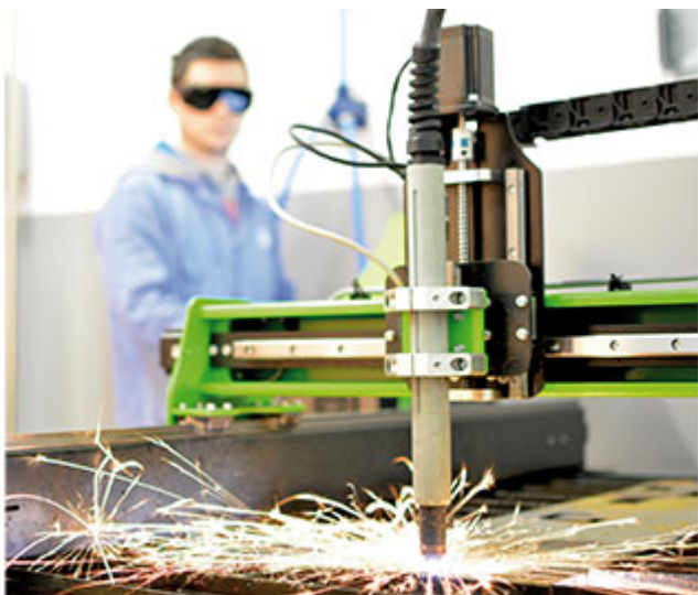
Avec les imprimantes 3D, la découpe plasma fait partie des équipements les plus utilisés.
