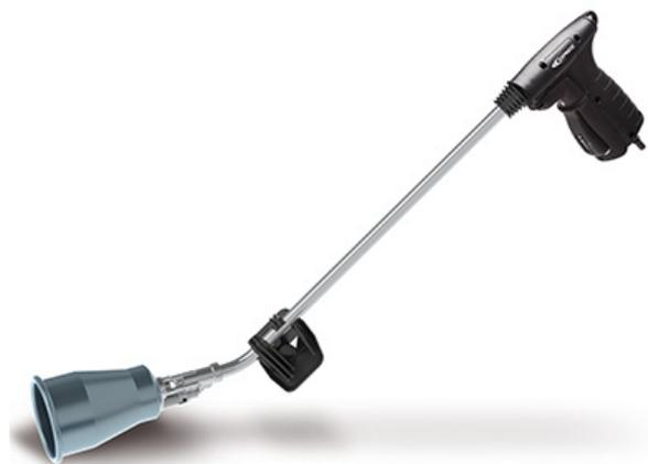
Les nouvelles lances Titane R Express sont compatibles via un raccord rapide avec les chalumeaux Raptor équipés d'une poignée sécurité munie d'un système allumage électrique automatique de type Piezo garantissant un grand confort d'utilisation ainsi qu'une parfaite sécurité, le chalumeau s'éteignant lorsque l'opérateur lâche la poignée.
